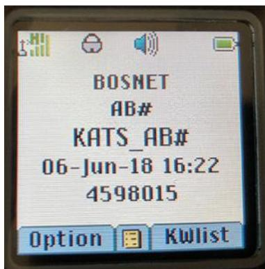
Nach Betätigen der Softkey-Taste\*<sup>1</sup> unter **Anlage** wechselt das Funkgerät sofort in die Gruppe der eingegebenen Kurzwahlnummer.
