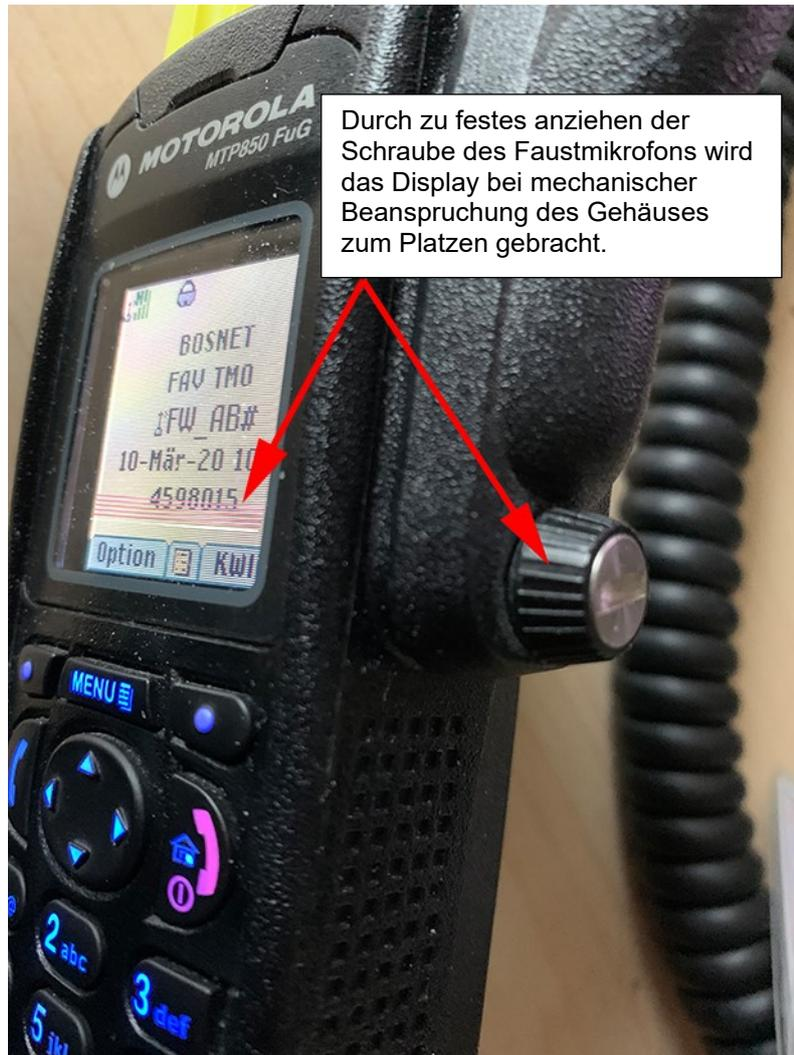
Bei manchen Feuerwehren wurde die Befestigungsschraube des Faustmikrofons (RSM) mit einem Werkzeug (Schraubendreher, Münze, etc.) angezogen.
