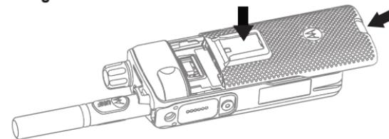
Legen Sie den Akku in das Fach ein. Schieben Sie den Akku zum oberen Ende des Funkgeräts hin, bis ein Klicken zu hören ist.
