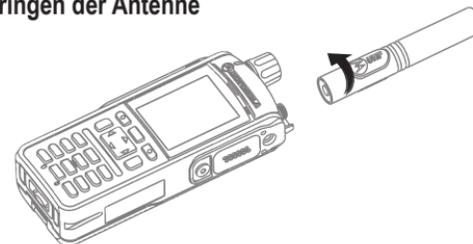
Schalten Sie das Funkgerät aus, bevor Sie die Antenne anbringen. Richten Sie das untere Ende der Antenne und die Schraubbefestigung am oberen Ende des Funkgeräts aus. Drehen Sie sie im Uhrzeigersinn, bis sie fest sitzt. Wenden Sie keine übermäßige Kraft an.
