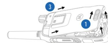
1. Schieben Sie die Akkuverriegelung nach rechts, und halten Sie sie fest.
